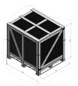
Holz\_MSII Stand. Für MegaSlate Module (Dach, Fassade), Dachplatten, VSG-Gläser oder Thermiemodule
